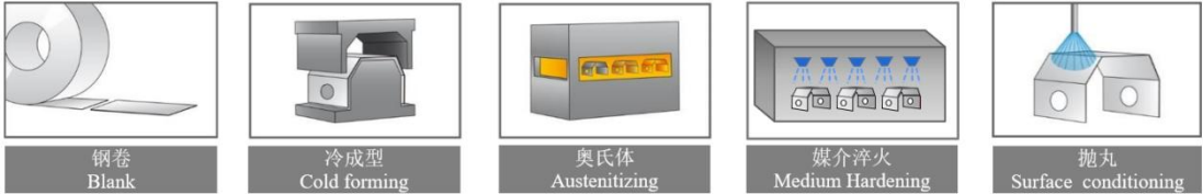
图：公司 MHP 工艺示意图
