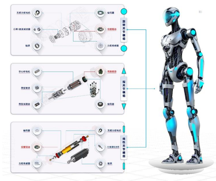
图 5：采用 EtherCAT 协议作为关节通信的具身机器人及灵巧手，红圈内的伺服驱动模块均会用到 EtherCAT 芯片
