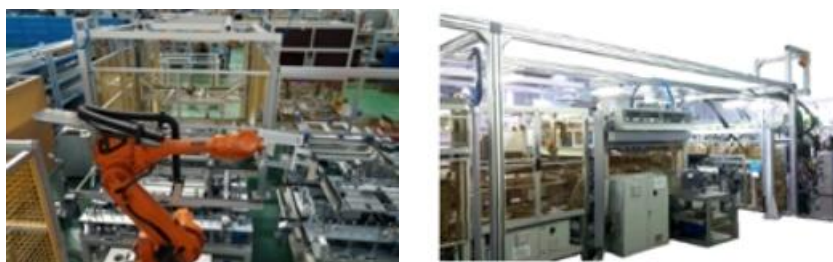
汽车全景天窗智能组装生产线
