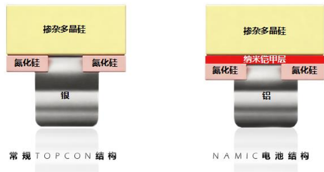
图 1.Namic 电池与常规 TOPCon 电池结构对比图
