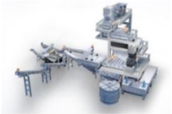
废铅酸蓄电池破碎分选设备是废铅酸蓄电池再生利用产业的核心
