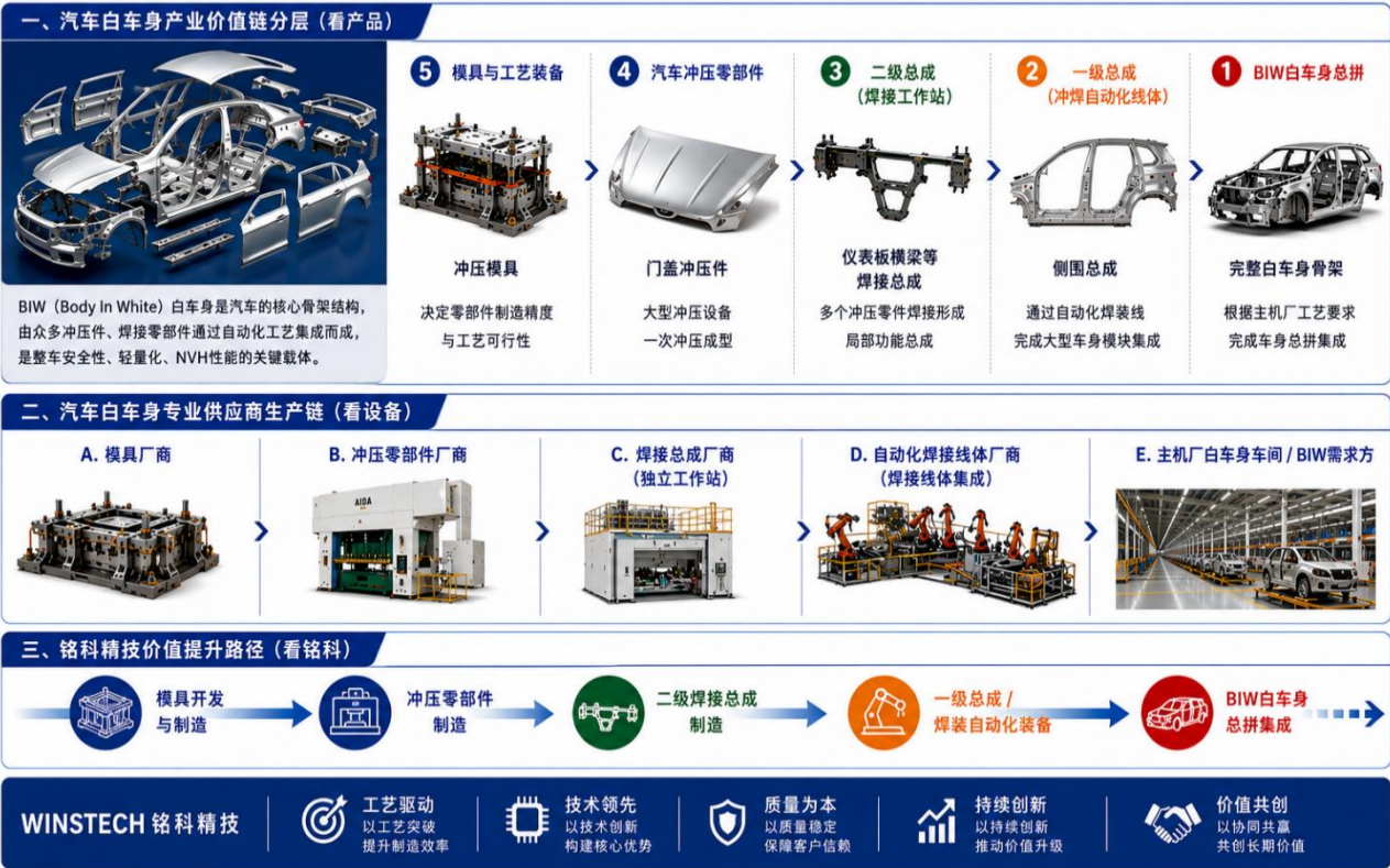
汽车白车身 (BIW) 产业价值链全景图 — 从模具、冲压到焊装集成，纵览汽车BIW制造价值链
