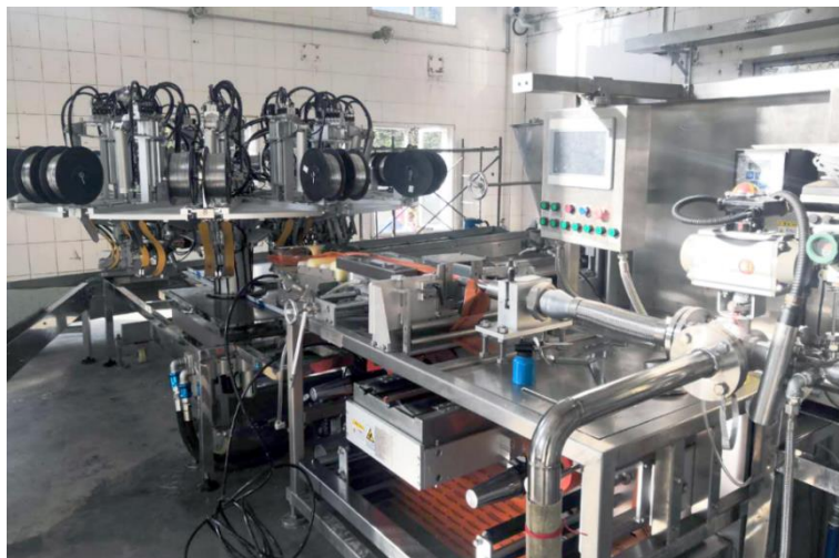
（JWL-RW 系列回转式金属丝打卡装药系统）
