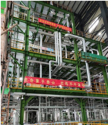
华龙一号整体效应试验装置
