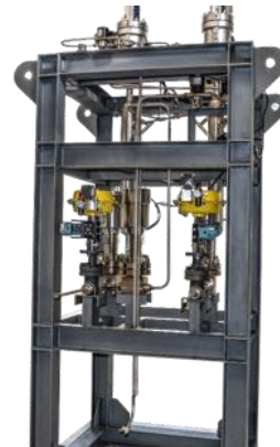
钠水反应试验装置
