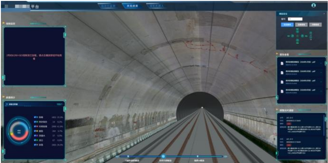
高铁隧道巡检平台
