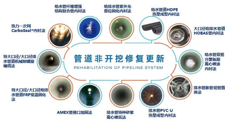
图 14 12 类管道非开挖修复更新工法
