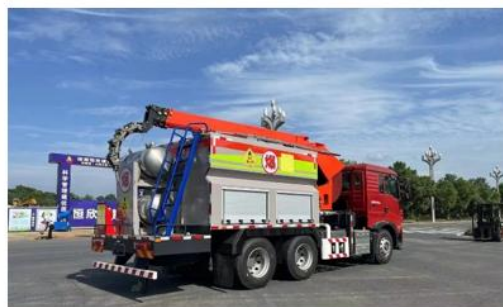
图八 长距离智能乳化炸药车
