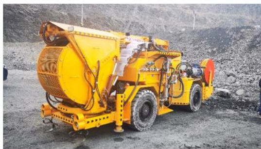
图七 乳化炸药地下装药车
